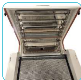
7 lampes de chauffe sur 2 zones indépendantes
