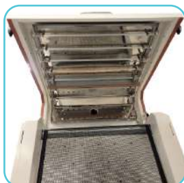
7 lampes de chauffe sur 2 zones indépendantes
